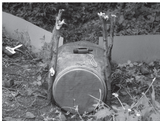
Figura 4. Sistema colector de sedimentos.
