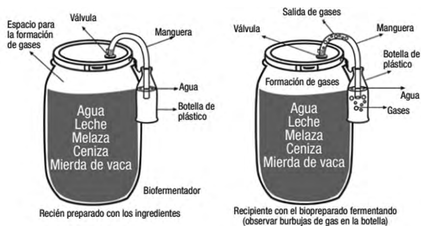
Figura 14. Proceso de fermentación anaeróbica con tambos herméticamente sellados y válvula de escape de gases. Fuente: Archivo ICT.
