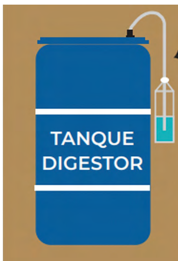
Figura 15. Tanques herméticamente sellados y válvula de escape de gases. Fuente: Secretaría de Agricultura y Desarrollo Rural (2022).
