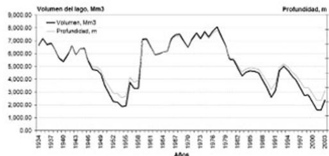
Figura 1 Variaciones de volumen y de profundidad media anual del lago de Chapala en el periodo (1934-2003).
