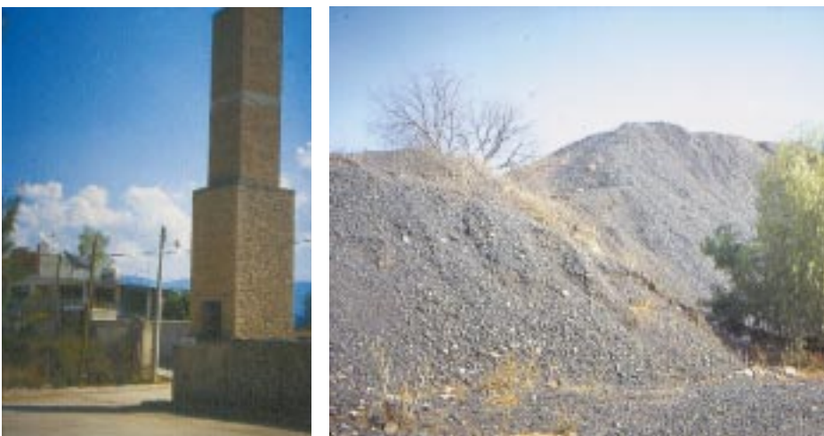
FIGURA 5. Escorias y chimenea de antigua fundidora. Los humos de las fundidoras que operaron en Zimapán contaminaron con arsénico los suelos cercanos. La acción de la lluvia y el riego ha provocado la infiltración de parte de este arsénico hacia el acuífero somero.
